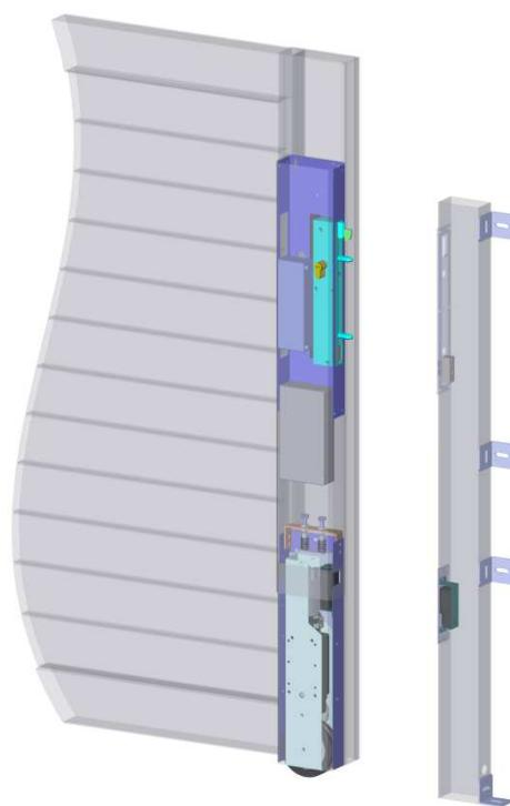
Hauteur 900 / 1300 mm Largeur 120mm Epaisseur 50mm
