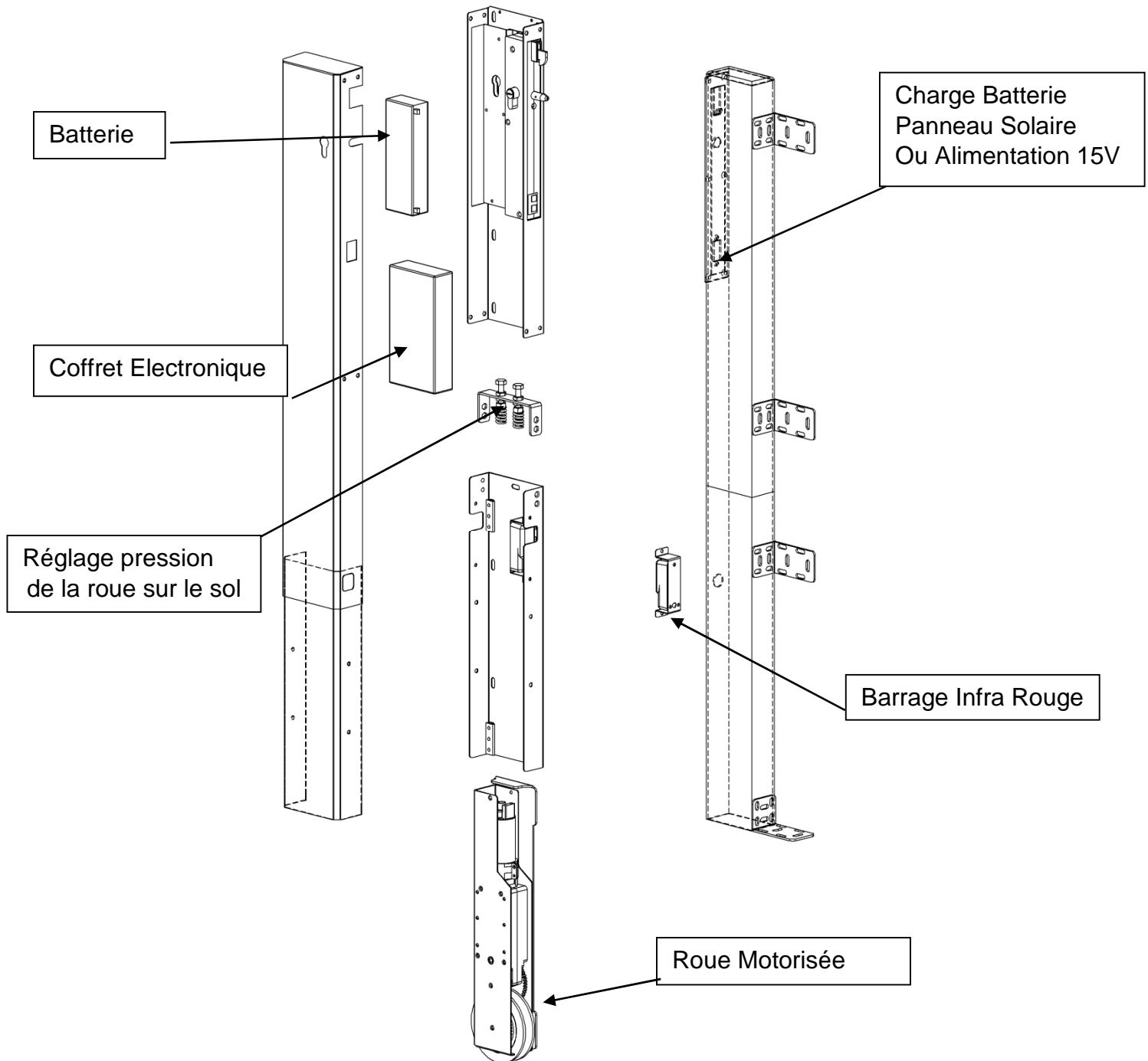
Hauteur réglable 900 / 1300mm, Largeur 120mm Epaisseur 50mm
