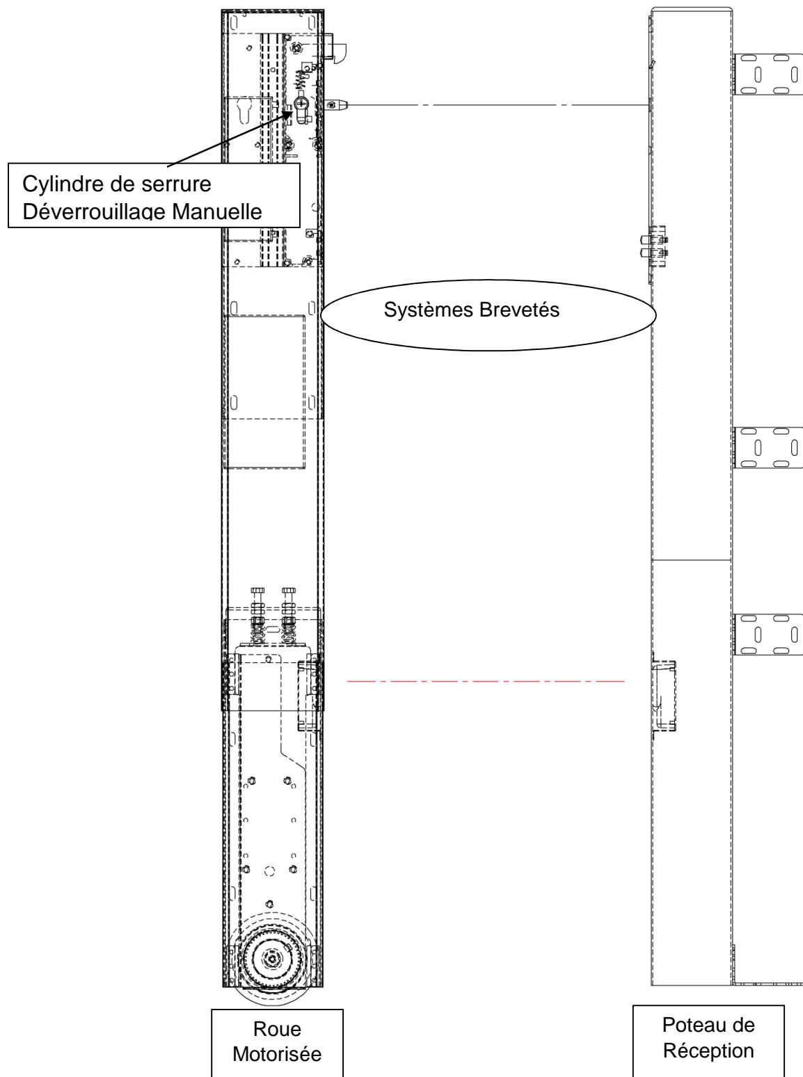
Hauteur 900 / 1300 mm Largeur 120mm Epaisseur 50mm
